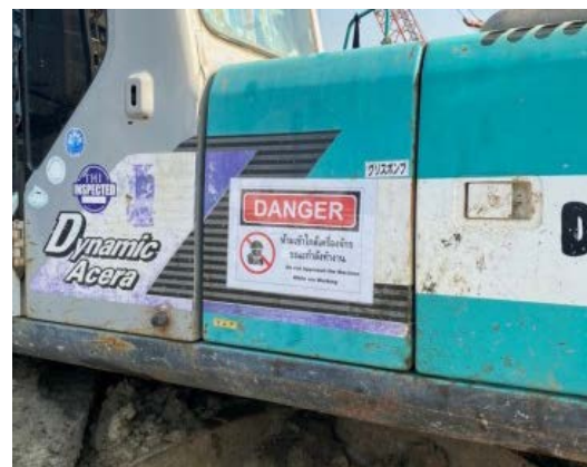
รูปที่ 33 สัญญาณเตือนขณะเครื่องจักรทำงาน และป้ายเตือนอันตรายจากเครื่องจักร
